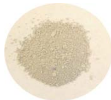
クリーンバーンによる完全燃焼後の灰
